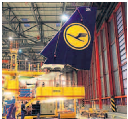
Ein Kran hebt das sechs Meter hohe Leitwerk auf den Lufthansa-Airbus
